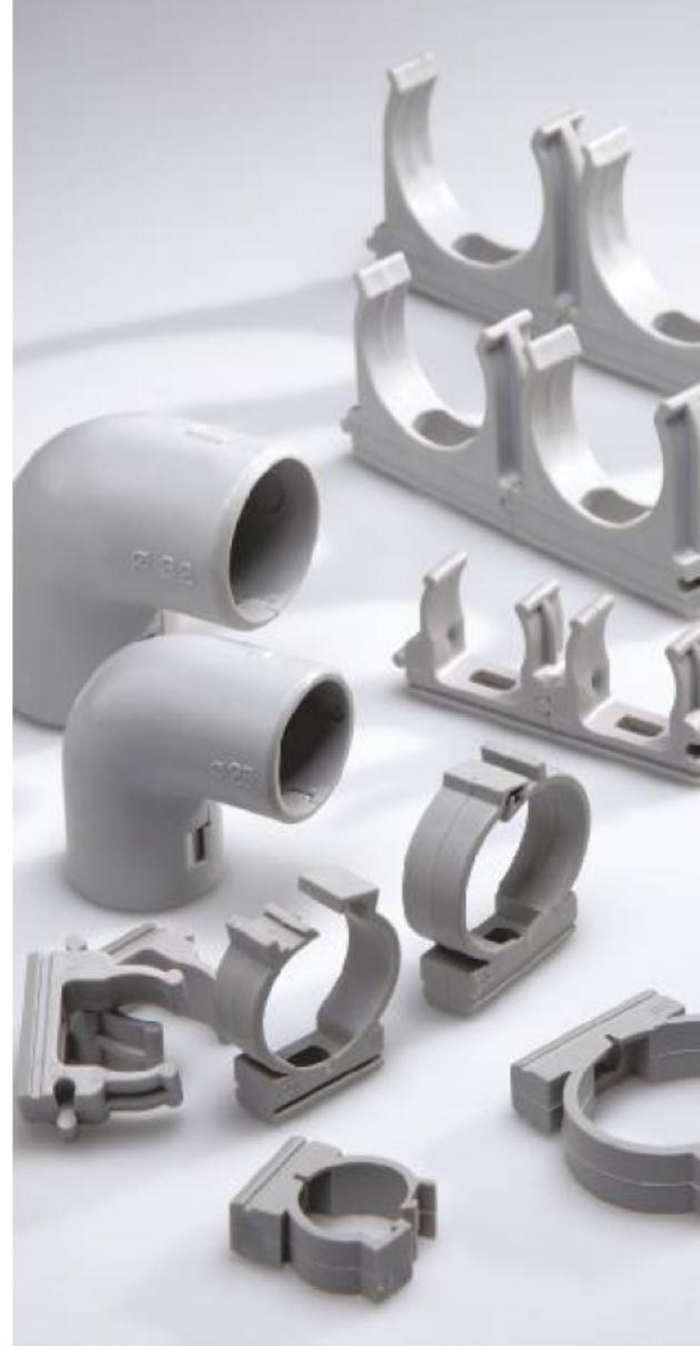
Παράγονται από ειδικά σταθεροποιημένες θερμοπλαστικές A' ύλες, μεγάλης αντοχής, ελεύθερες βαρέων μετάλλων (RoHS) και αλογόνων, αυτοσβενόμενες που δε διαδίδουν τη φλόγα. Διατίθενται σε χρώμα γκρι RAL 7035. Κατασκευάζονται βάσει προτύπου ELOT EN 61386 με μεγάλη αντοχή στην κρούση και την συμπίεση για θερμοκρασίες εγκατάστασης από -25°C έως και +60°C.
