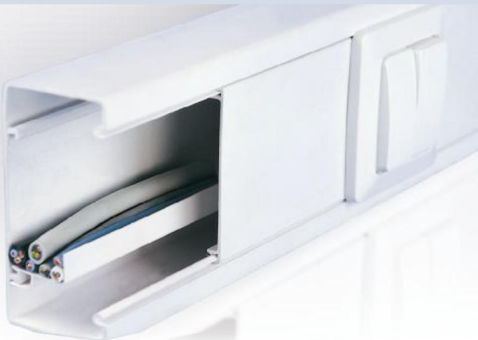
Τα ηλεκτρολογικά κανάλια 100X35 mm και 100X50mm διαθέτουν ολοκληρωμένη σειρά εξαρτημάτων και συναρμολογούνται σε πλήρες σύστημα διαχείρισης καλωδίων. Το διαχωριστικό ρεύματος-δεδομένων παρέχει ασφάλεια στην εγκατάσταση. Η στήριξη των διακοπών με τις αγκράφες επιτρέπει την εύκολη τοποθέτηση οποιουδήποτε είδους διακόπη αλλά κυρίως την τοποθέτηση διακοπών πολλαπλών στοιχείων οποιασδήποτε μάρκας και οπουδήποτε αριθμού στοιχείων.
